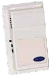
• **Sensor de habitación T56:** El sensor que se instala en la habitación; su información de temperatura se envía a la unidad. Incluye una función de anulación del modo ocupado y una función de ajuste de temperatura de  $\pm 3\text{ }^{\circ}\text{C}$  (con intervalos de 1 K) (opcional).
